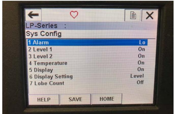
그림 28: 시스템 구성 메뉴 화면
