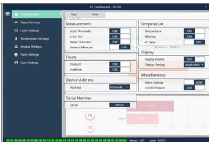
Fig. 5: A aba Configuration (Configuração) permite que o transmissor de nível seja configurado para a aplicação específica.
